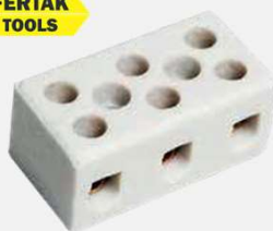
CONECTOR DE PORCELANA TRIPOLAR CÓDIGO: 8204 – 10 A – 250V – 10 MM² 12/300 CÓDIGO: 8205 – 30 A – 600V – 16 MM² 12/300
